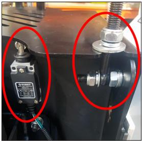
**Hydraulikschläuche von Vor-Rücklauf Einzugswalze (11) sichern**
