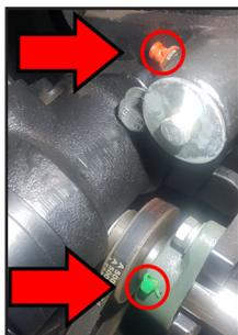
1. Reinigen Sie die Schmiernippel mit einem Lappen.
