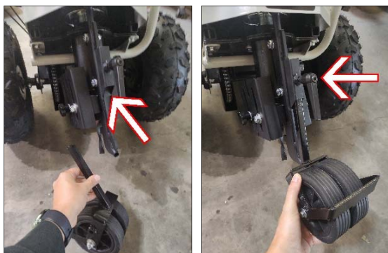
Lenk- und Wälzrad einstellen und montieren
