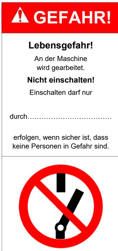
Abb. 3: Beispiel für ein Warnschild zum Sichern gegen Wiedereinschalten
