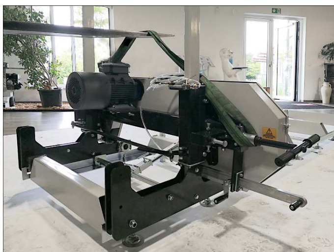
Sägekopf mit Fahrgestell auf den Schienenweg ablegen, Abbildung BSW-76GL
