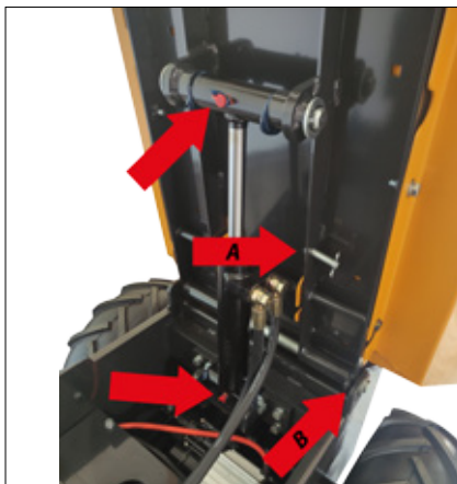
Die Schmierstellen des Hydraulikzylinders alle 20 Betriebsstunden nachschmieren.
