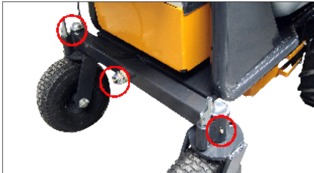
Die Drehpunkte der Pendelachse alle 80 Betriebsstunden nachschmieren.
